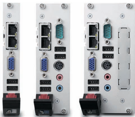
Рис. 2. Варианты исполнения платы sPCI-3610
