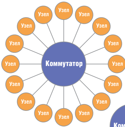
Рис. 9. Сетевая топология типа «звезда»
