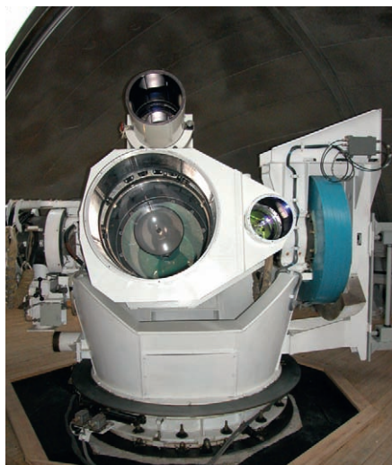
Рис. 2. Телескоп траекторных измерений первой очереди АОЛЦ
