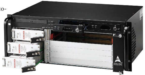
Рис. 13. Внешний вид конструкции платформы cPCIS-6400U
