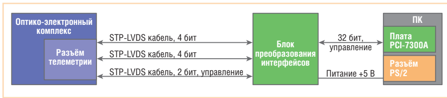
Рис. 3. Структурная схема телеметрической системы
