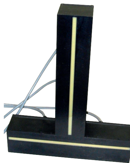
Рис. 5. Приёмно-излучающая антенна экспериментального стенда
