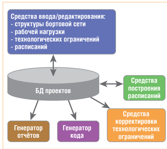
Рис. 4. Структура инструментальной системы «САПР циклограмм»
