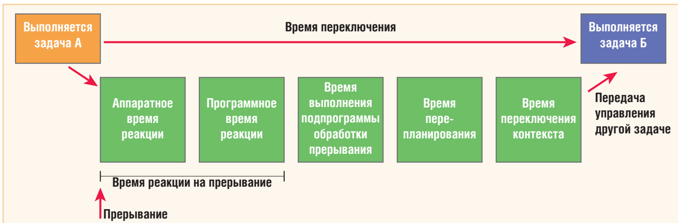
Рис. 1. Реакция ОС на прерывание (с перепланированием)
