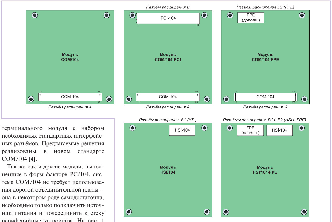
Рис. 2. Общий вид компоновки модулей COM/104
