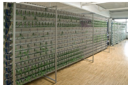
Рис. 4. EtherCAT для больших систем: к одному мастер-контроллеру по шине E-bus подключено более 10 000 модулей ввода-вывода
