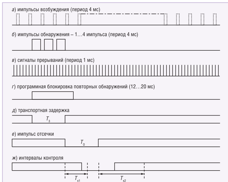
Рис. 1. Диаграмма, поясняющая временные соотношения в функционировании подсистем сепаратора
