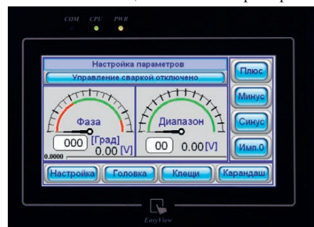
Рис. 3. Панель управления установкой контактной сварки
