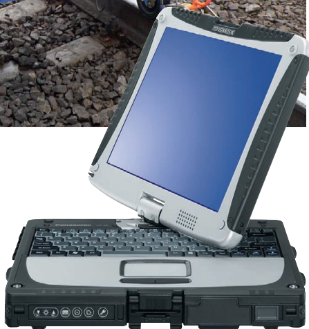
Рис. 6. Защищённый ноутбук Panasonic CF-19 – составная часть диагностической аппаратуры
