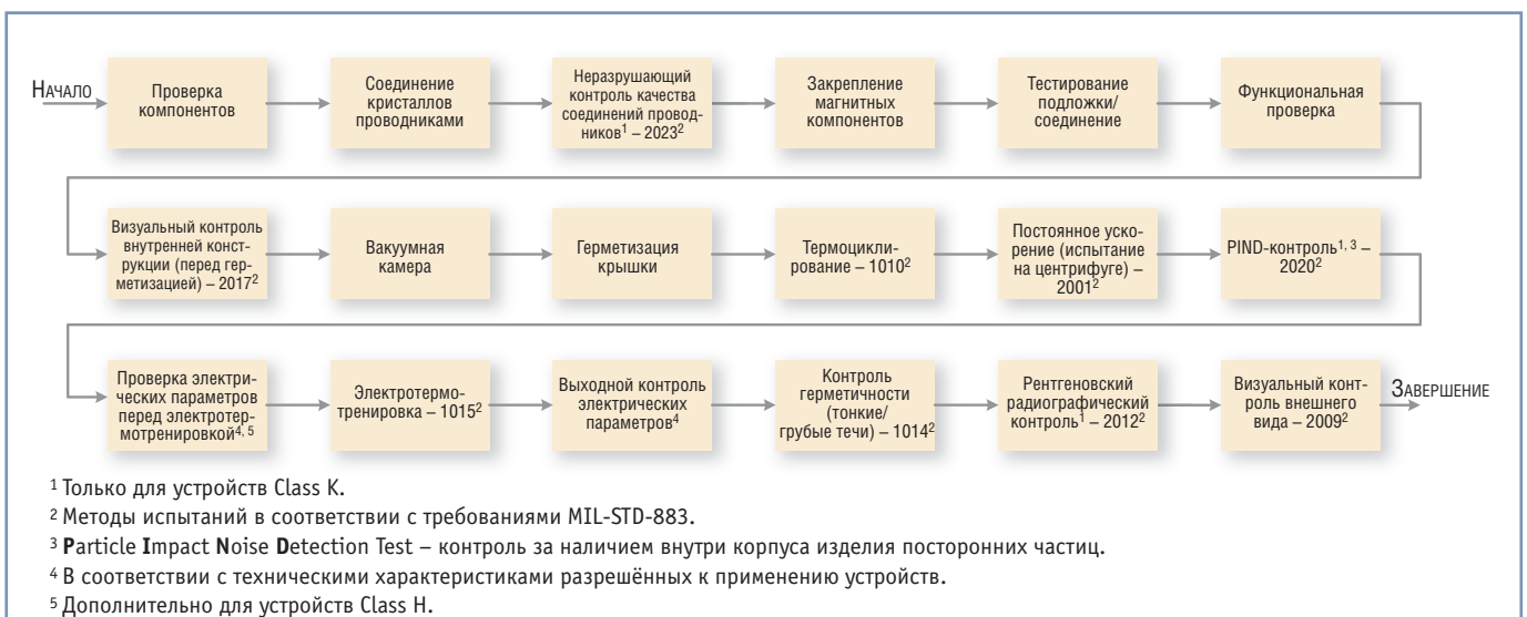
Рис. 4. Производственный технологический процесс и последовательность отборочных испытаний гибридных модулей
