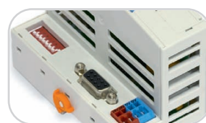
CPM704 • Протокол передачи данных PROFIBUS DP V1 • Сетевой интерфейс PROFIBUS
