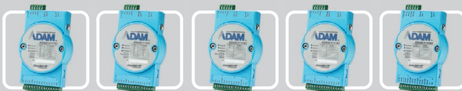
ADAM-6117EI 8-канальный изолированный аналоговый модуль ввода (Ethernet/IP)
