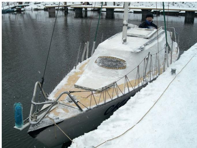
Рис. 4. Размещение ультразвукового датчика на выносной консоли, закреплённой на носу яхты
