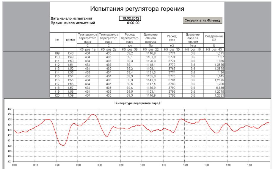
Рис. 7. Экранная форма протокола испытаний регулятора горения
