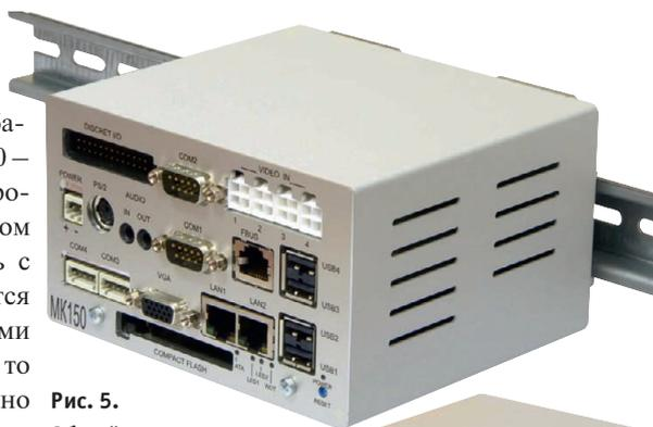
Рис. 5. Общий вид модульного компьютера МК150-01
