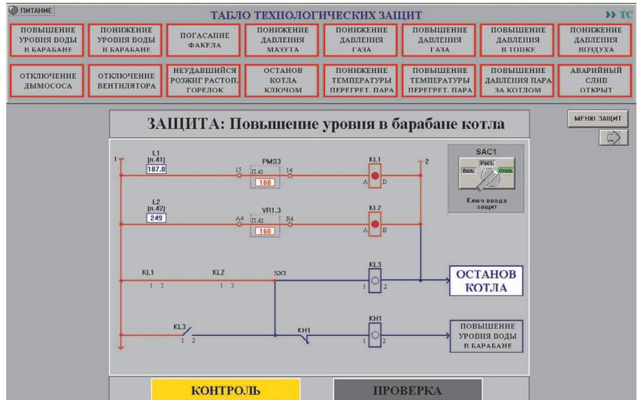
Рис. 6. Экран контроля состояния технологических защит
