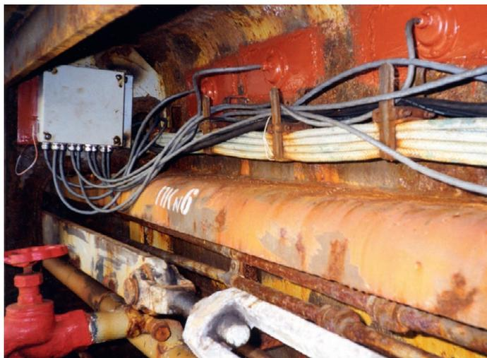
Рис. 1. Удалённый измерительный модуль и датчики системы СПР-3М, установленные на комингсе теплохода «Путеж»
