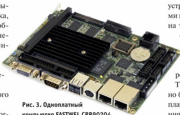
Рис. 3. Одноплатный компьютер FASTWEL СРВ90204, составляющий основу универсального контроллера СРМ902-01
