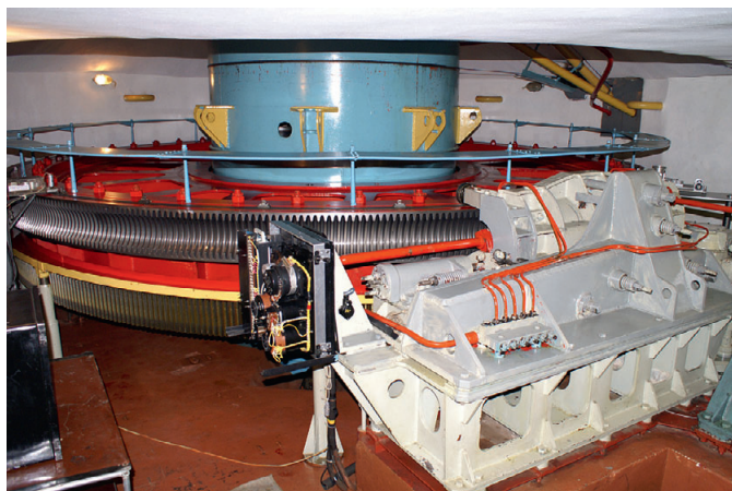
Рис. 4. Привод азимутальной оси с открытым отсчётным блоком
