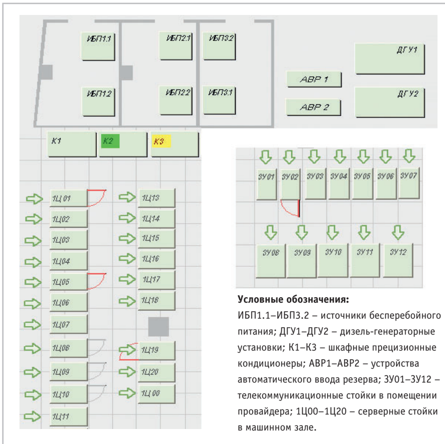
Рис. 1. Пример организации отображения на основе фрагментов поэтажных планов
