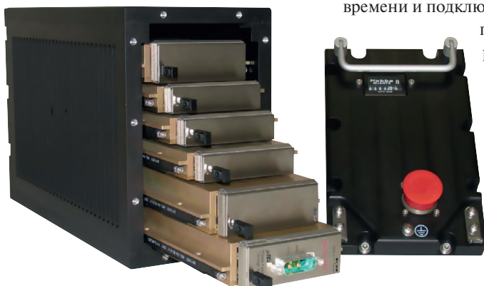
Рис. 1. Пример вычислительной системы с кондуктивным охлаждением по спецификации MicroTCA.3
