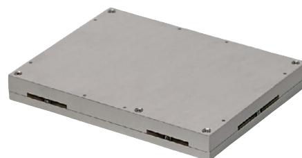
Рис. 2. КМ формата ESMexpress XM51 с процессором QorIQ P4080 в защитном алюминиевом корпусе
