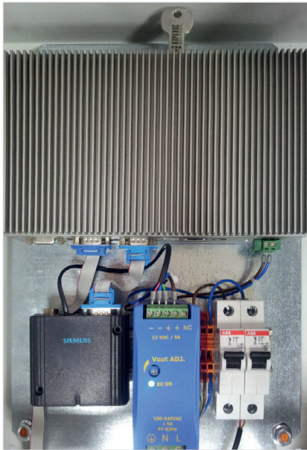
Рис. 6. Внешний вид конструкции «Модуля К»
