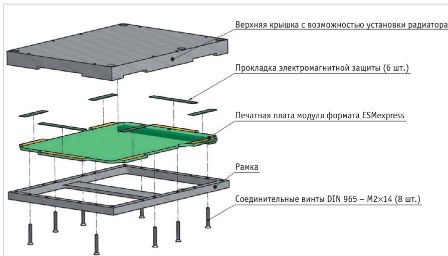
Рис. 1. Схема конструкции КМ ESMexpress согласно стандарту ANSI/VITA 59
