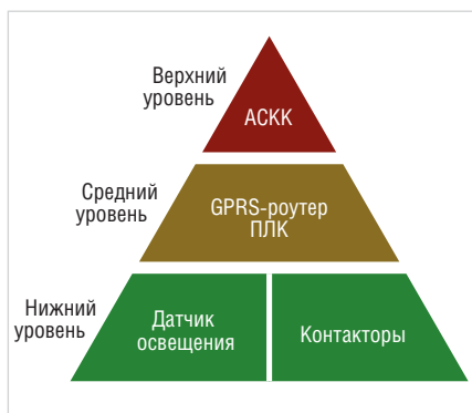
Рис. 8. Классическая трёхуровневая архитектура систем диспетчерского контроля
