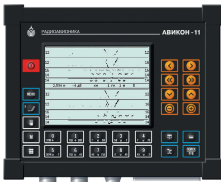
Рис. 3. Отображение на экране дефектоскопа АВИКОН-11 сигналов по всем каналам контроля в виде развёртки типа В
