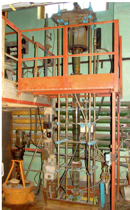
Рис. 2. Вибрационная колонна высотой 5 м и диаметром 110 мм
