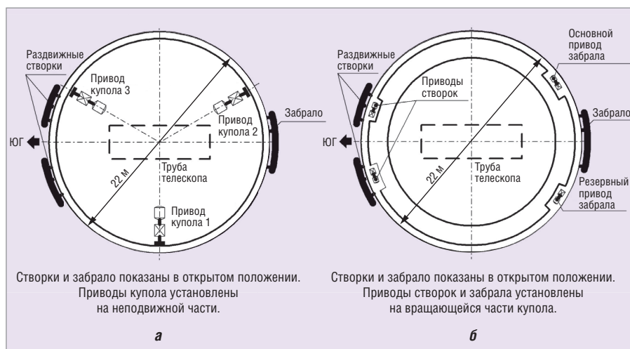
Рис. 3. Расположение электроприводов: а – привод купола; б – приводы забрала и створок
