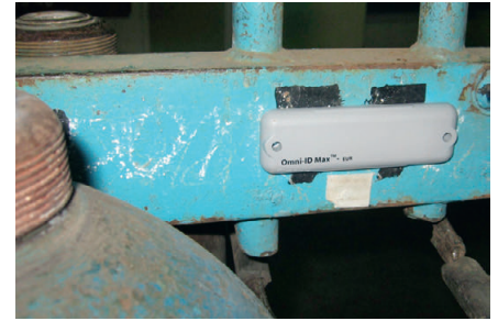
Рис. 3. RFID-метка на контейнере
