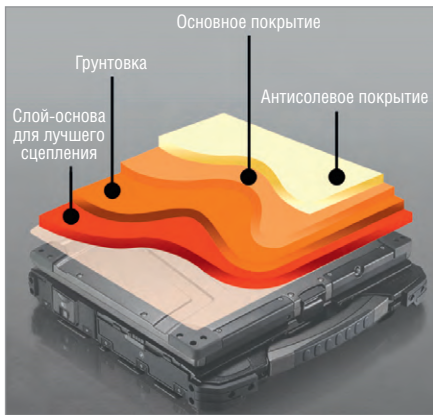
Рис. 6. Структура защитного покрытия корпуса ноутбука
