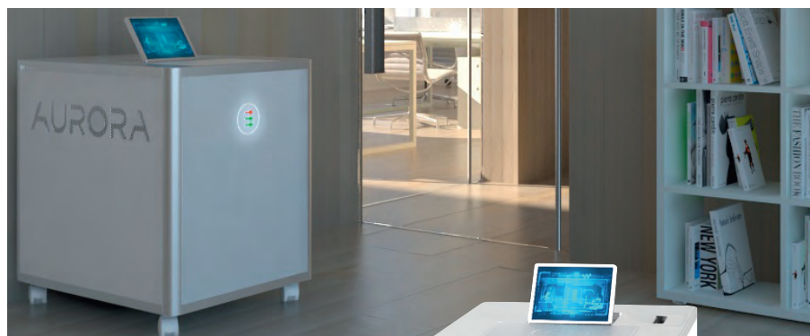
Рис. 6. НРС Aurora с внутренним охлаждением
