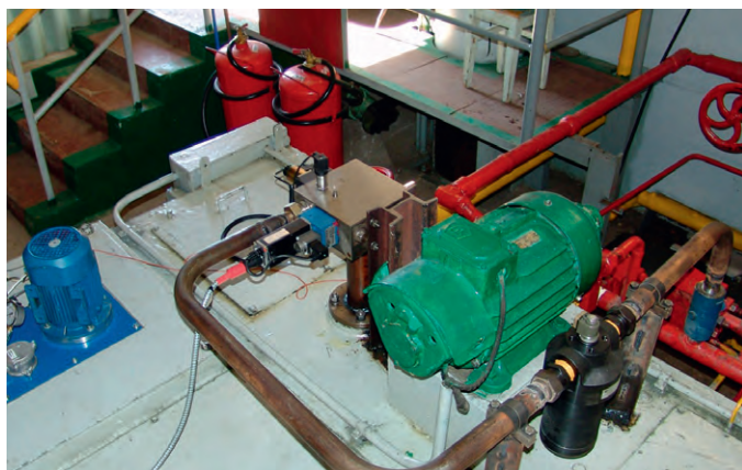
Рис. 6. Экспериментальные узлы управления адаптивного гидропривода
