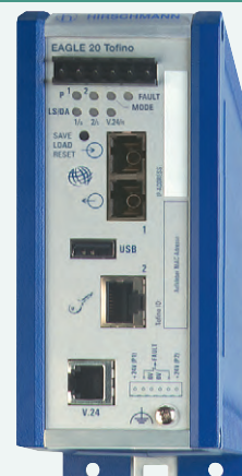
Рис. 6. Промышленный межсетевой экран Hirschmann Eagle Tofino с программным модулем обеспечения безопасности Tofino OPC Enforcer
