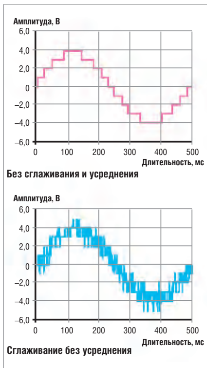
Рис. 21. Эффекты размывания и усреднения синусоидального сигнала
