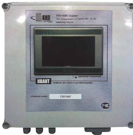
Рис. 2. Лицевая панель шкафа контроллера весового терминала со встроенной панелью MT8070iH
