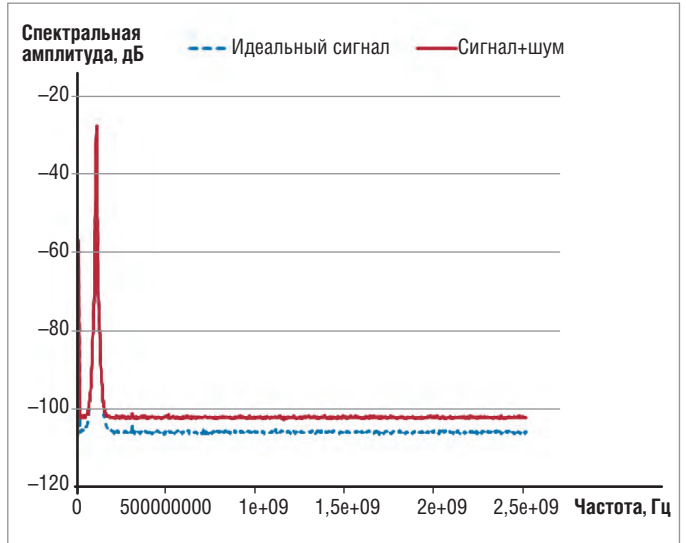
Рис. 8. Спектр затухающего синусоидального сигнала с белым шумом и без него
