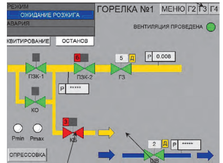
Рис. 7. Мнемосхема подсистемы управления розжигом горелки № 1
