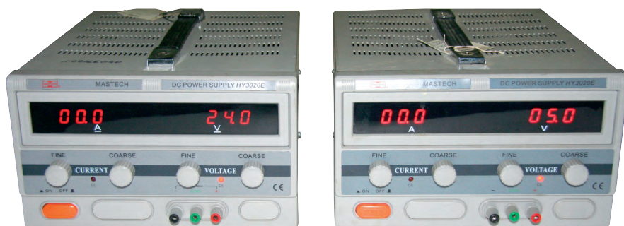
Рис. 7. Блоки питания постоянного тока напряжением 5 и 24 В
