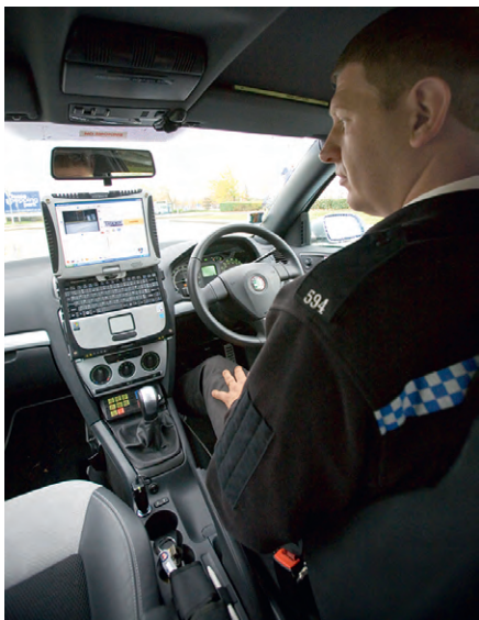
Рис. 1. Ноутбук CF-19 на док-станции в полицейском автомобиле
