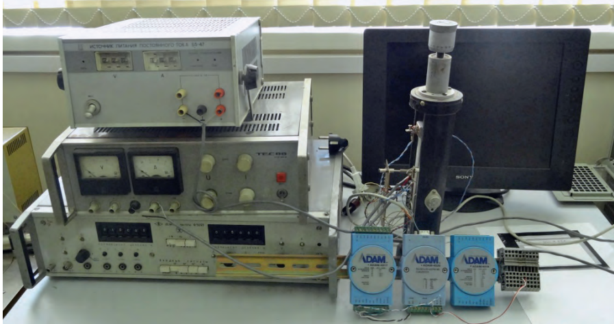
Рис. 8. Лабораторная установка для исследования температурных волн
