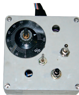
Рис. 3. Технологический пульт управления с ручным задатчиком положения штока пневмоцилиндра-позиционера
