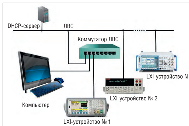
Рис. 5. Открытая конфигурация ЛВС с DHCP-сервером
