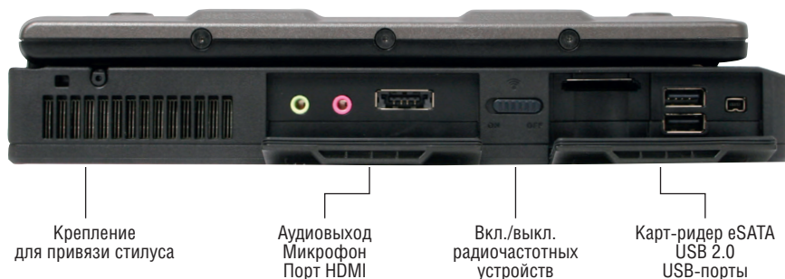
Рис. 6. Расположение портов на левой панели ноутбука S400
