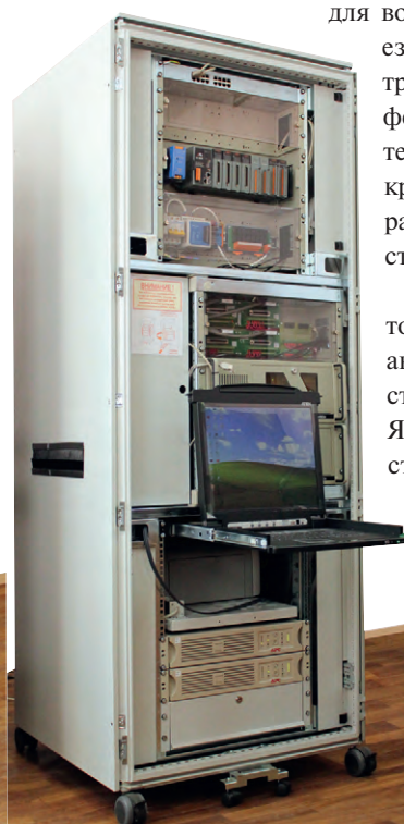
Рис. 2. АСУ ТП системы энергоснабжения Московского метрополитена
