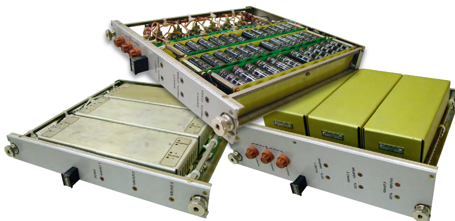
Рис. 6. Блок управления, блок контроля и силовой блок
