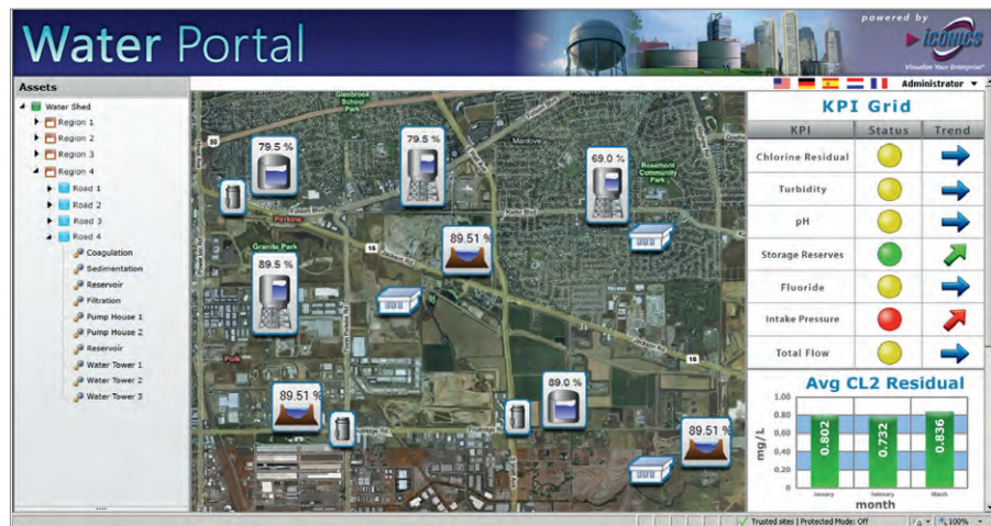
Рис. 2. Система управления активами в проекте водоснабжения Бирмингема
