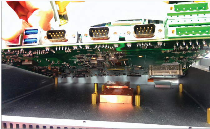
Рис. 2. Внутренняя конструкция системы пассивного охлаждения
