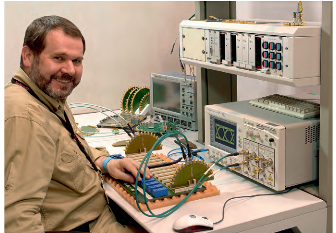
Рис. 3. Проверка целостности сигналов готовой кросс-платы
