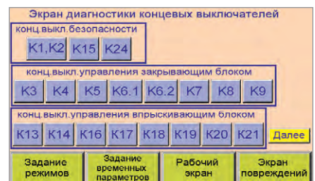
Рис. 9. Экран диагностики концевых выключателей
