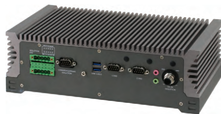
Рис. 1. Защищённый встраиваемый компьютер AAEON AEV-6356 (а – вид спереди, б – вид сзади)
