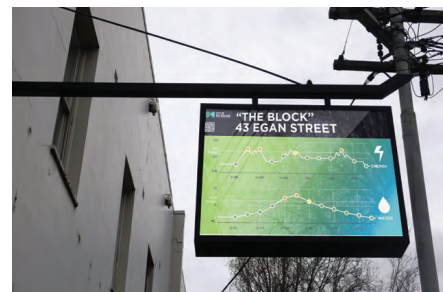
Рис. 8. Табло, отображающее параметры энергобаланса здания
