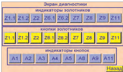
Рис. 10. Экран диагностики золотников и кнопок
