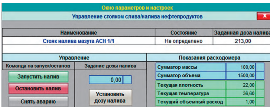
Рис. 6. Окно параметров и настроек для управления стояками налива мазута
