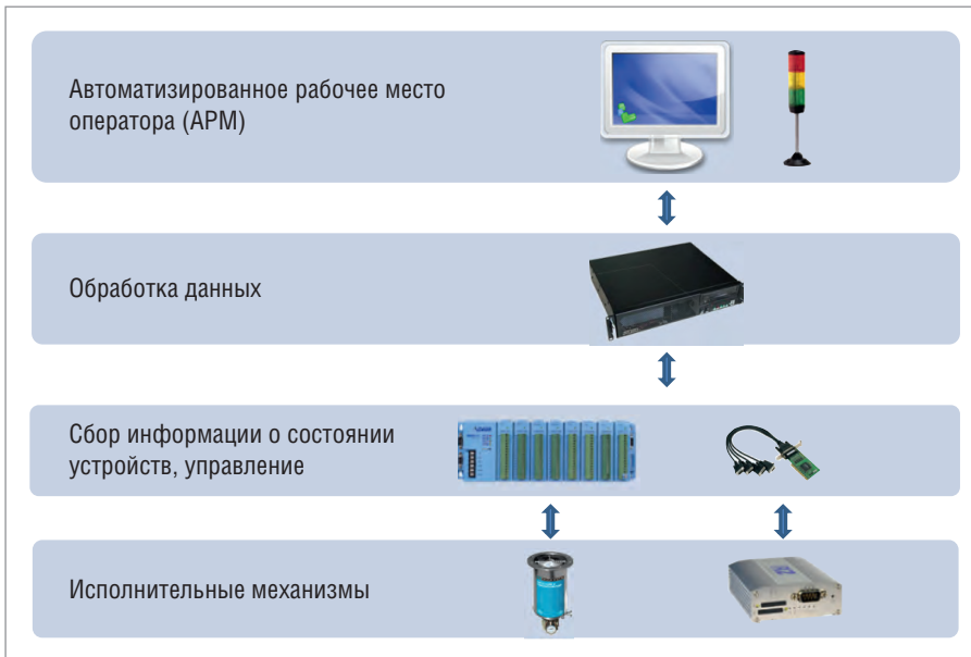
Рис. 2. Состав системы управления
