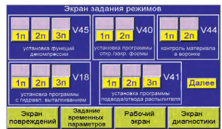
Рис. 6. Экран задания режимов, переключатели V18, V40, V41, V44, V45
