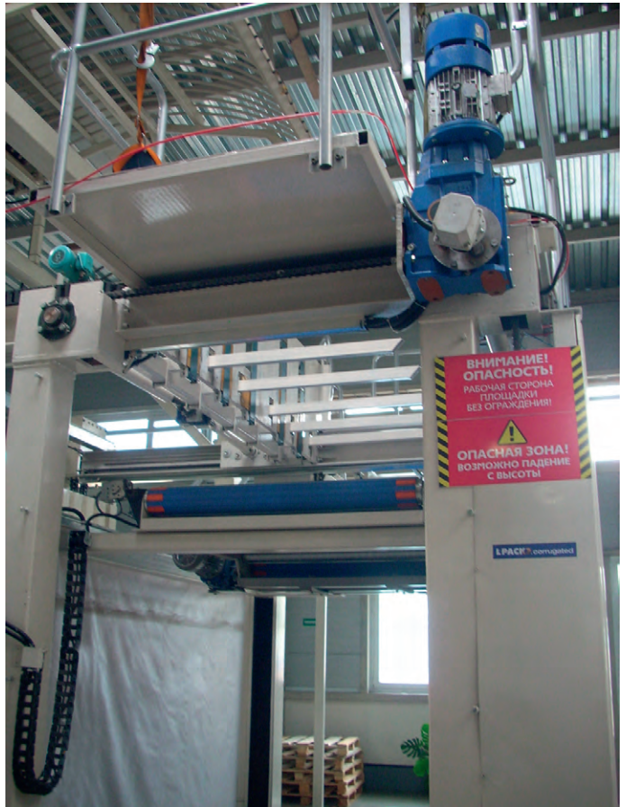
Рис. 5. Главный привод подъёмника с блоком концевых выключателей
