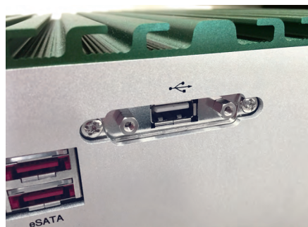
Рис. 4. USB-разъём с фиксацией на AdvantiX ER-5000
