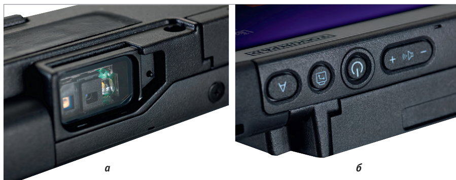
Рис. 5. Расположение на модели FZ-B2 сканера штрих-кодов (а) и кнопку управления планшетом (б)
