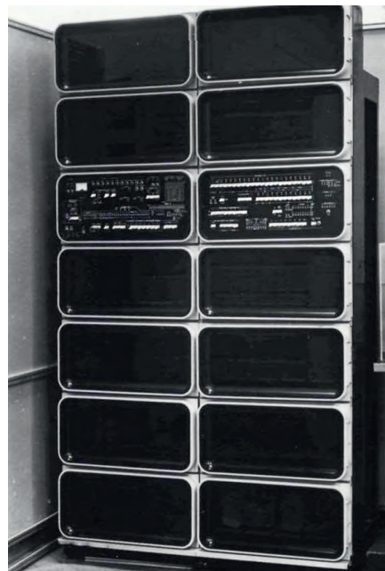
Рис. 5. Типовой шкаф ЭВМ М-13
