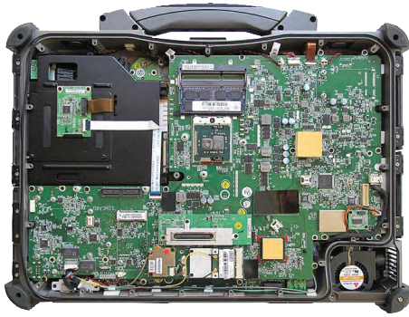
Рис. 2. Ноутбук X500 без нижней крышки
