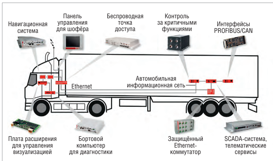
Рис. 1. Современное транспортное средство, оснащённое компьютерными платформами в разных форм-факторах
