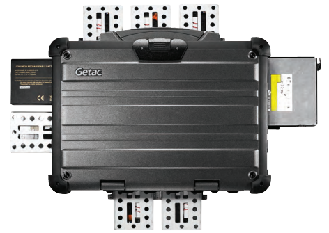
Рис. 7. X500 Mobile Server с установленными дополнительными НЖМД с функцией RAID
