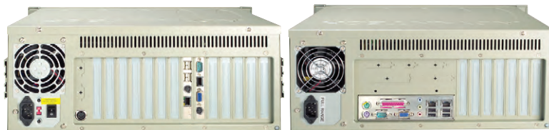
Рис. 1. Компьютерный корпус в форм-факторе PICMG (14 слотов) и ATX (7 слотов)
