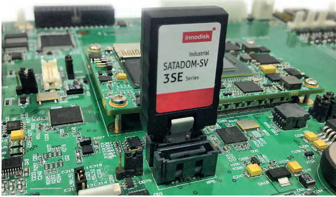
Рис. 3. Накопитель SATADOM с технологией питания Pin 7 VCC
