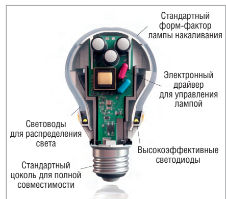
Рис. 10. Устройство LED-лампы 3M LED Advanced Light в стандартном корпусе
