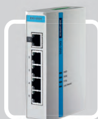
EKI-3525 • Неуправляемый коммутатор • 5×100Base-TX
