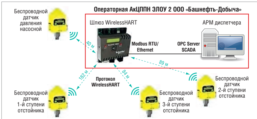
Рис. 4. Схема сбора данных по беспроводному протоколу WirelessHART на объекте
