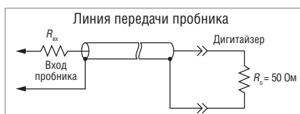
Рис. 20. Упрощённая схема линии передачи пробника, подключённого к аналоговому каналу дигитайзера с терминирующим сопротивлением 50 Ом
