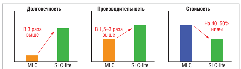
Рис. 3. Сравнение характеристик флэш-памяти на базе технологий SLC-Lite, SLC и MLC
