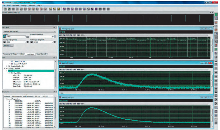
Рис. 42. Результат сегментированного опроса смоделированного лазерного импульса с короткими пиками и длительным интервалом покоя
