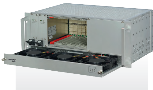
Рис. 3. Пример 19" системы CompactPCI с резервированием
