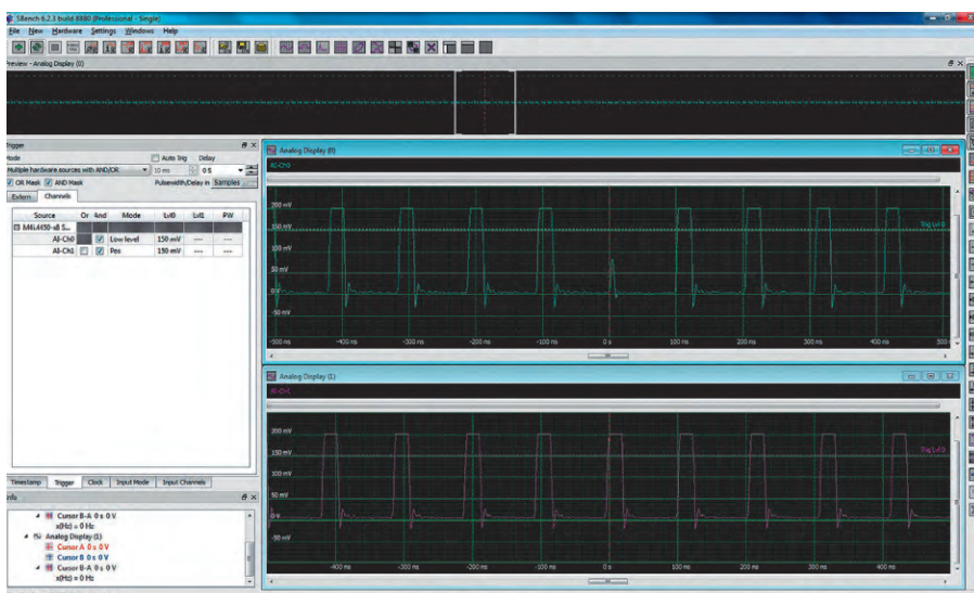
Рис. 34. Ещё один пример использования функции запуска по функции И с элементом инверсной логики (режим низкого уровня на Ch0). Запуск происходит, когда, в отличие от канала Ch1, на Ch0 импульс отсутствует
