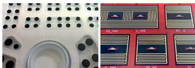
Рис. 4. Резиновая мембрана с угольными контактами и печатная плата с проводящими дорожками
