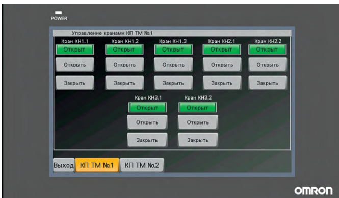
Рис. 7. Экран информации о состоянии кранов системы телемеханики КПТМ № 1
