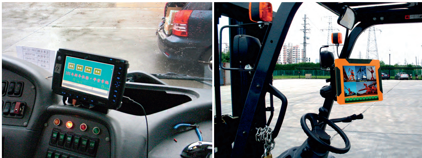
Рис. 8. Транспортные панельные компьютеры IEC, установленные в автомобиле и на погрузчике
