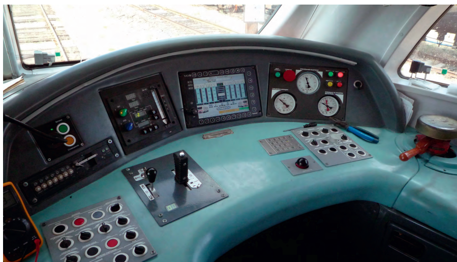
Рис. 9. Отечественный интегрированный пульт индикации и управления FASTWEL BM301-02 в кабине машиниста
