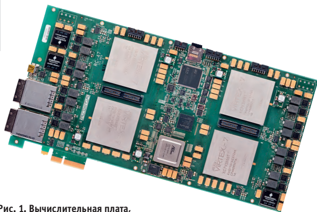
Рис. 1. Вычислительная плата, для которой разрабатывался теплоотвод
