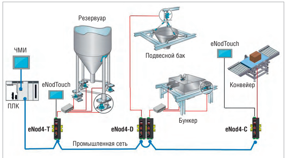
Рис. 7. Пример единой архитектуры весоизмерительных систем на базе преобразователей-контроллеров eNod4
