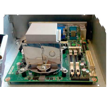
Рис. 13. Установленный на плате теплопроводящий модуль FHC высотой 70 мм
