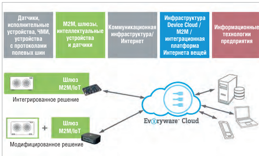
Рис. 5. Архитектура Eurotech может использоваться как для стандартных M2M-решений, так и для задач по модернизации существующих систем
