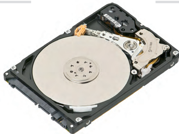
Рис. 1. Внешний вид механического жёсткого диска со снятой крышкой
