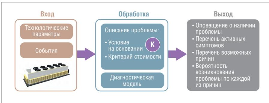
Рис. 13. Схема работы модуля предиктивной диагностики неисправностей
