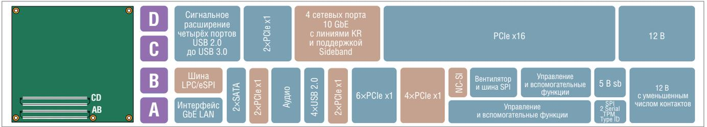
Рис. 1. Оптимизированная раскладка разъёма COM Express тип 7
