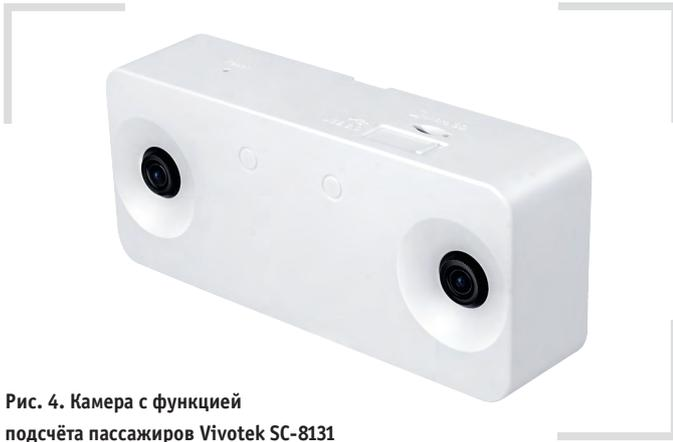
Рис. 4. Камера с функцией подсчёта пассажиров Vivotek SC-8131
