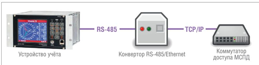
Рис. 6. Схема типового решения по интеграции узла учёта
