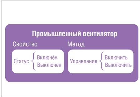
Рис. 2. Структурная схема класса, описывающего промышленные вентиляторы
