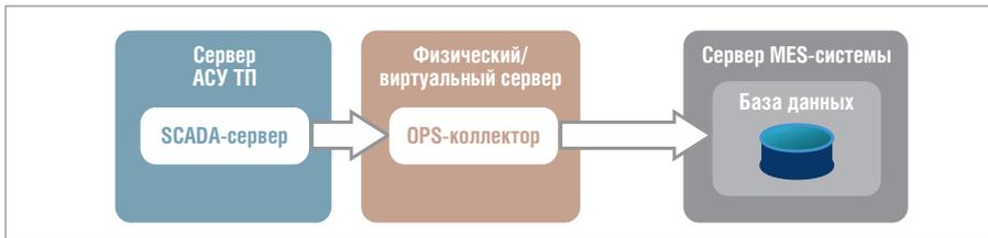
Рис. 9. Типовое решение, отражающее программную интеграцию АСУ ТП производств и установок
