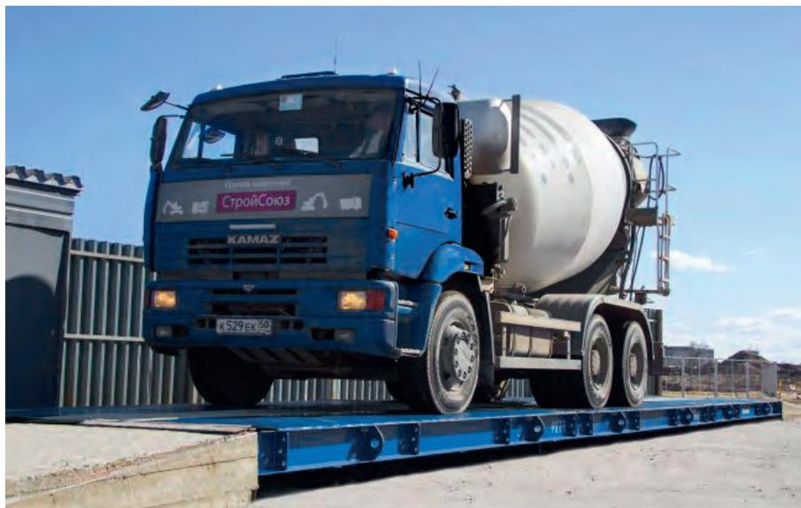
**Рис. 2. Автомобильные весы**
