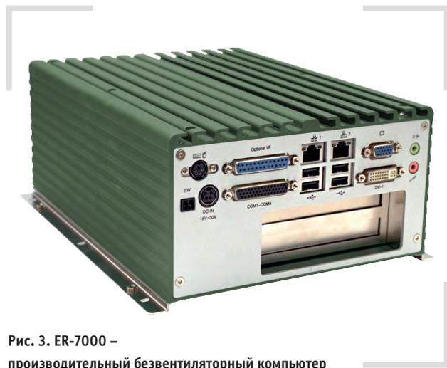
Рис. 3. ER-7000 – производительный безвентиляторный компьютер
