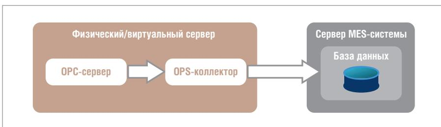
Рис. 7. Типовое решение, отражающее программную интеграцию узлов учёта
