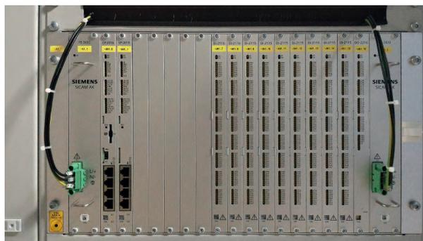
Рис. 6. Промышленный контроллер АК 1703 АСР
