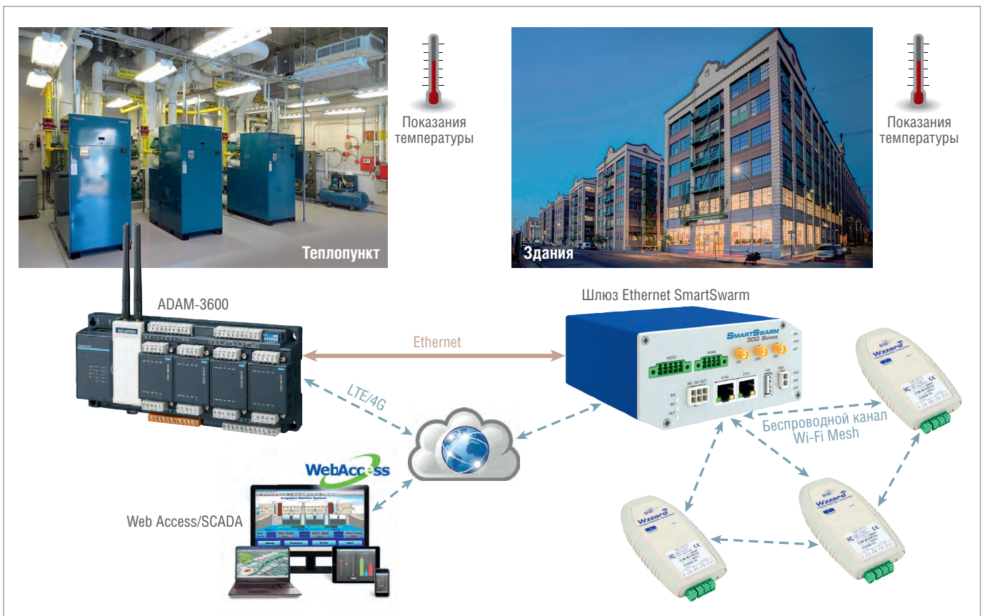
Рис. 2. Структура распределённой системы управления отоплением жилых массивов
