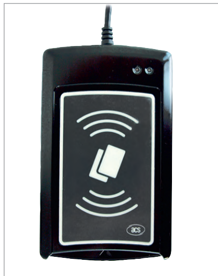
Рис. 11. Считыватель ACR1281U-C1 производства компании Advanced Card Systems
