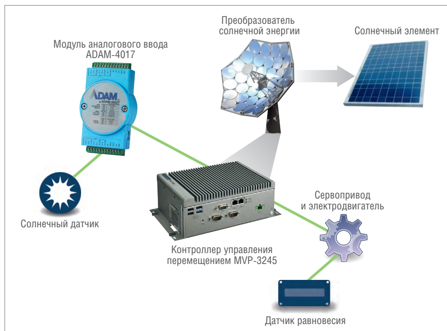
Рис. 4. Структура системы управления положением гелиоконцентратора
