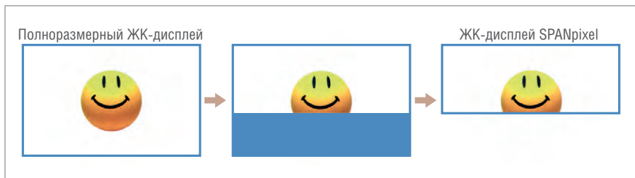
Рис. 9. Отображение полноразмерного медиаконтента на ЖК-дисплеях SPANpixel
