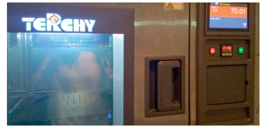
Рис. 3. Испытания при повышенных температурах (в климатической камере +70°C)
