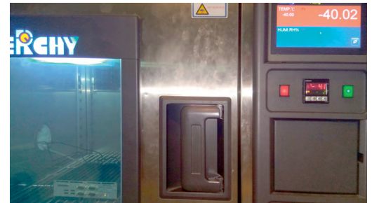
Рис. 4. Испытания при пониженных температурах (в климатической камере -40°C)
