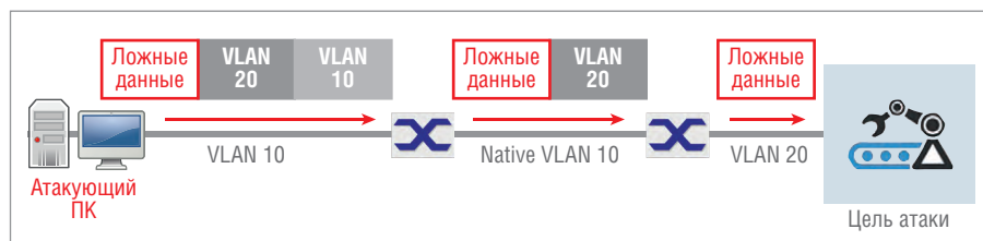
Рис. 4. Пример атаки типа VLAN hopping/Double tagging attack
