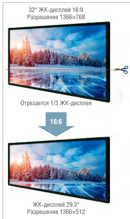
Рис. 6. Преобразование ЖК-дисплея формата 16:9 в формат 16:6
