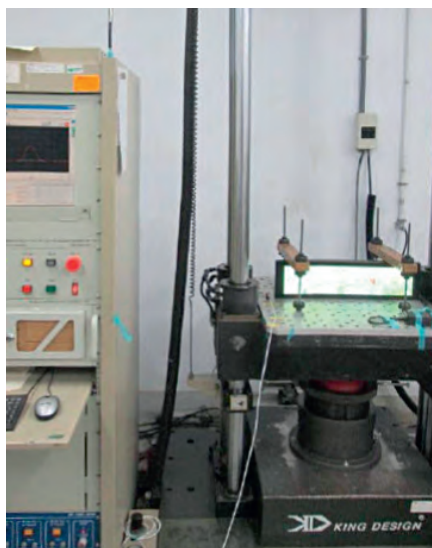
Рис. 7. Стенд испытаний на ударопрочность
