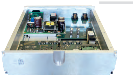
Рис. 3. Компоновка внутри корпуса компьютера BC50R
