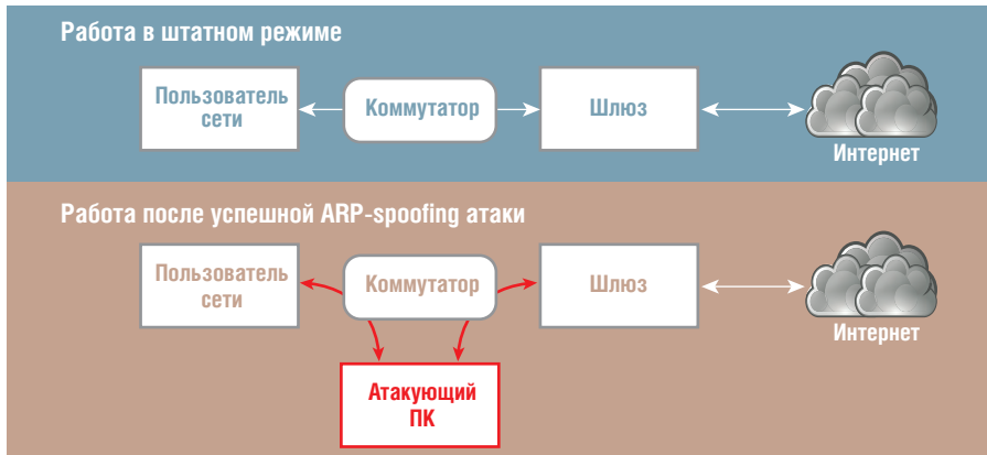
Рис. 2. Пример ARP-spoofing атаки
