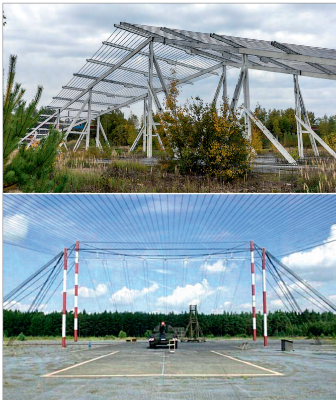
Рис. 4. Двухэлектродные стационарные испытательные стенды, предназначенные для испытания относительно крупных объектов на устойчивость к воздействию ЭМИ ЯВ
