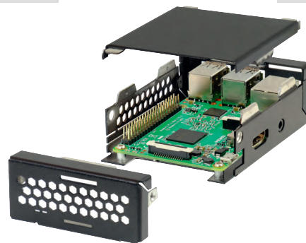
Рис. 17. Точка доступа в Интернет на основе модуля Raspberry PI в корпусе Interscale M
