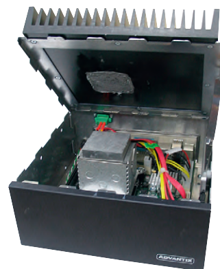
Рис. 19. Безвентиляторный компьютер на процессоре Core i5 в корпусе Interscale C
