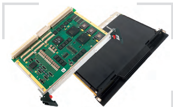
Рис. 1. Процессорная плата с тройным резервированием, соответствующая требованиям вплоть до DAL-A
