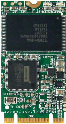
Рис. 1. Твердотельный накопитель Innodisk M.2 3SE3 32 Гбайт с размерами 22×42×3,5 мм
