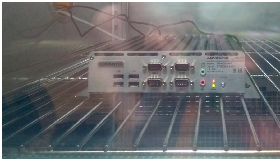
Рис. 1. Климатические испытания промышленного компьютера при -40^{\circ}\text{C}
