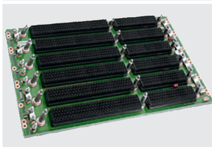
Рис. 6. VPX-коннектор RT2 и объединительная плата в военном исполнении
