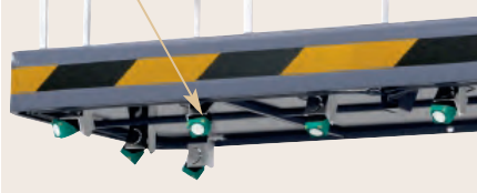
Рис. 8. Ультразвуковые датчики контролируют опасное сближение платформы с посторонними объектами
