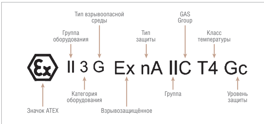
Рис. 5. Пример европейской маркировки взрывозащищённых изделий
