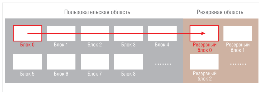
Рис. 4. SSD начинает запись в резервный блок 0
