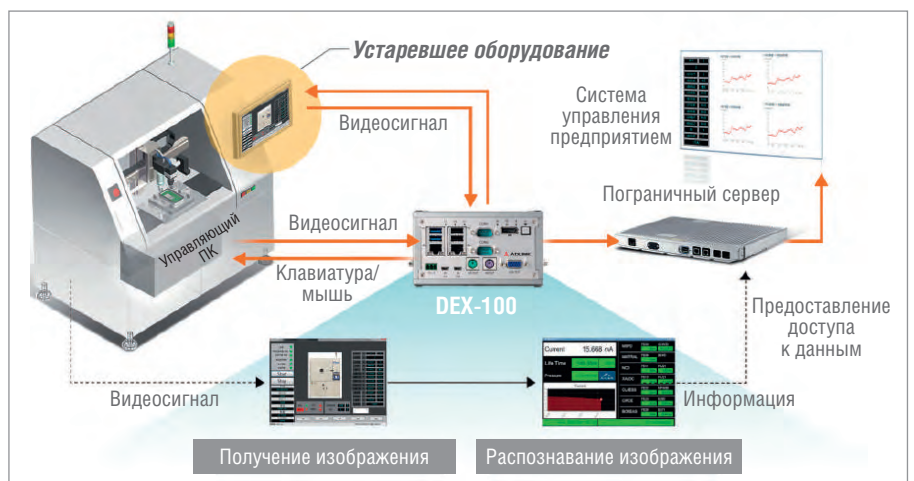
Рис. 3 . Распознавание экранных форм на базе ADLINK DEX-100
