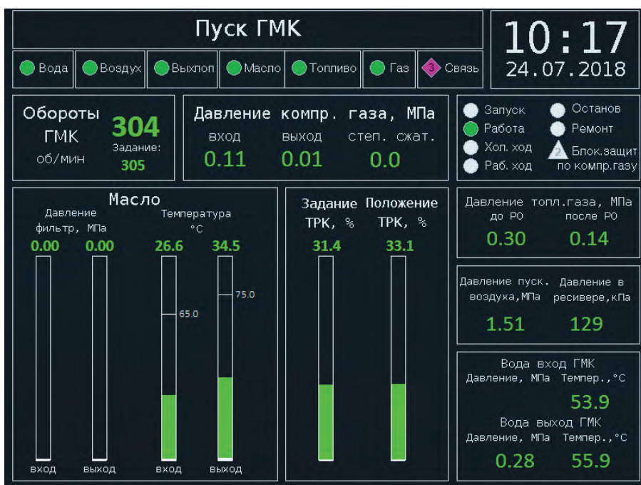
Рис. 5. Интерфейс пульта резервного управления ГМК
