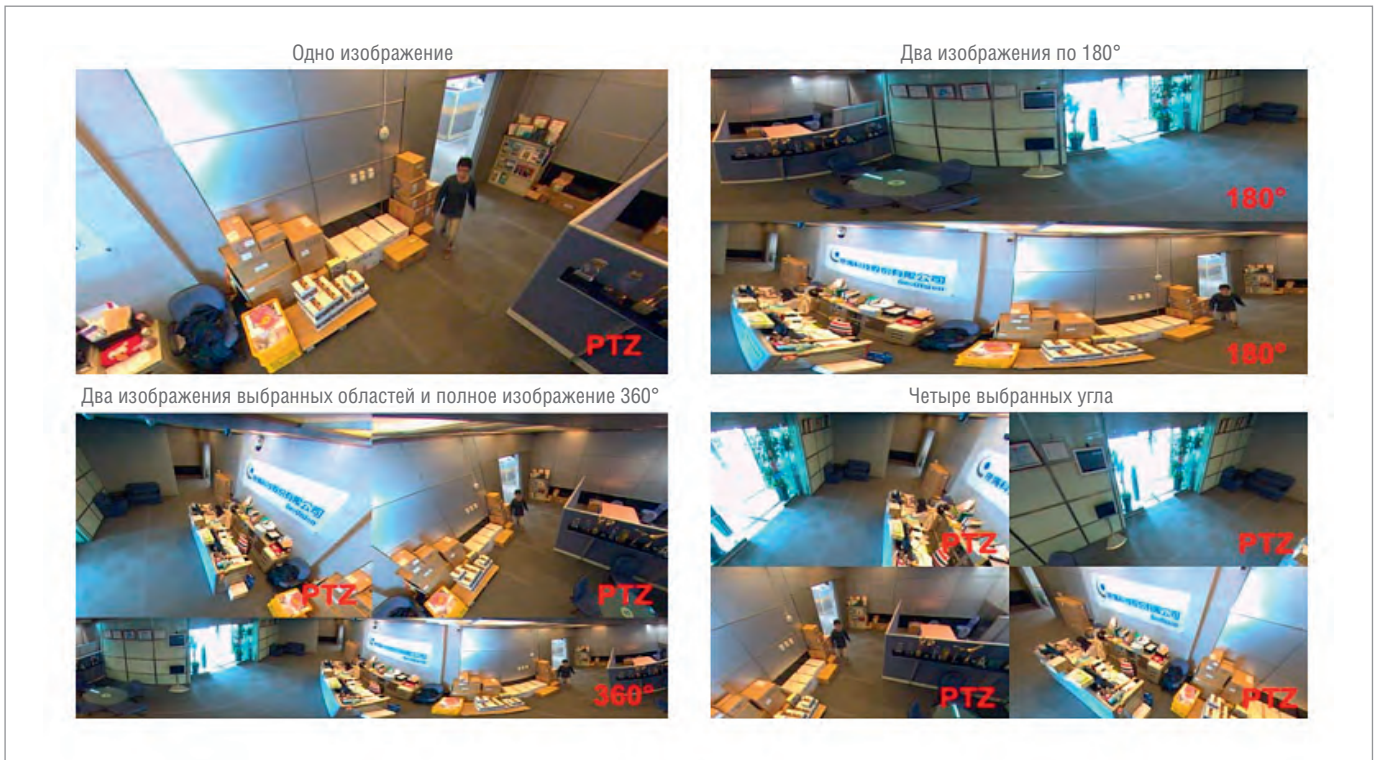
Рис. 3. Развёртка изображения камеры с объективом «рыбий глаз»
