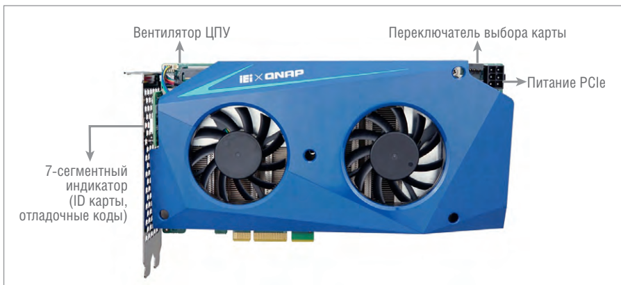
Рис. 6. Расположение коннекторов Mustang-200 с лицевой стороны
