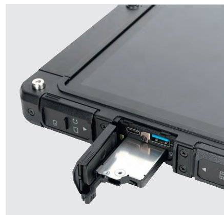
Рис. 2. Слот для размещения SSD-диска
