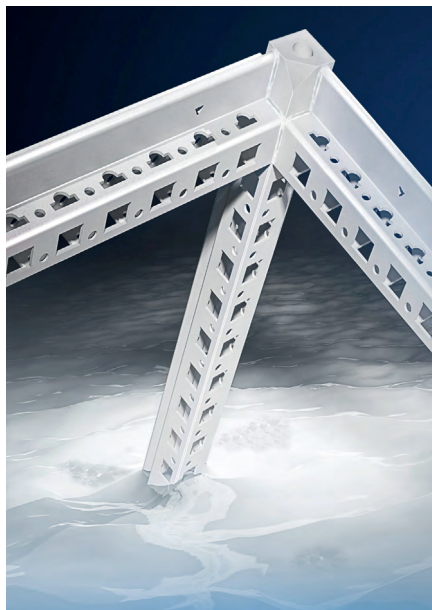
Рис. 4. Электрофорезное грунтование каркаса шкафа
