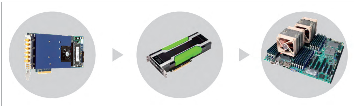
Рис. 4. Передача данных дигитайзера с помощью RDMA в графический процессор
