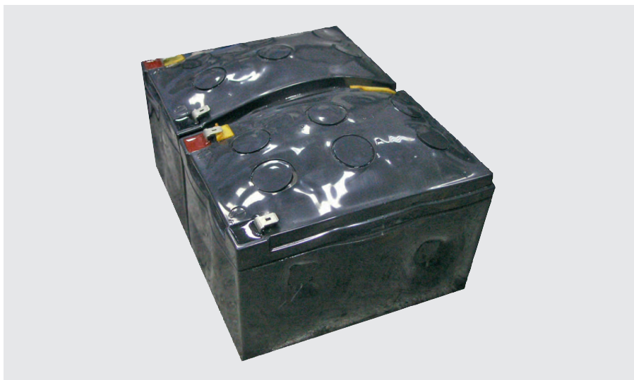
Рис. 2. Изменение геометрии корпуса в результате термического разгона
