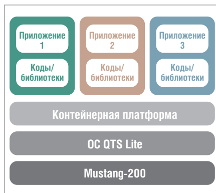
Рис. 4. Запуск контейнерных приложений на акселераторе Mustang-200
