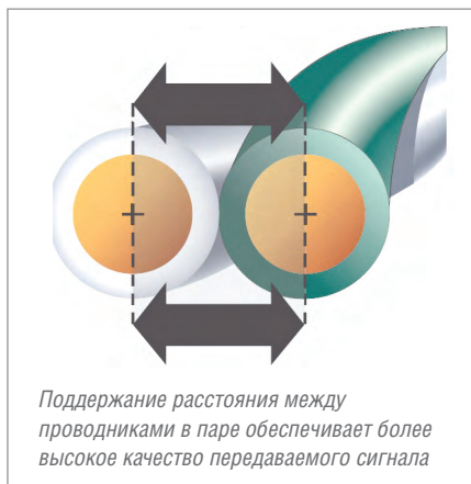
Рис. 6. Расположение проводников в спаянной витой паре
