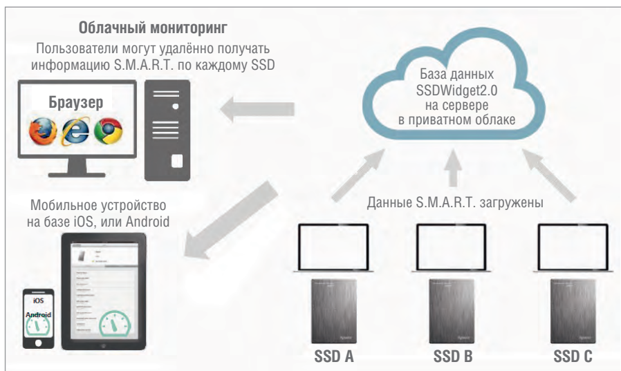
Рис. 4. SSDWidget2.0 – средство для удалённого контроля дисков SSD
