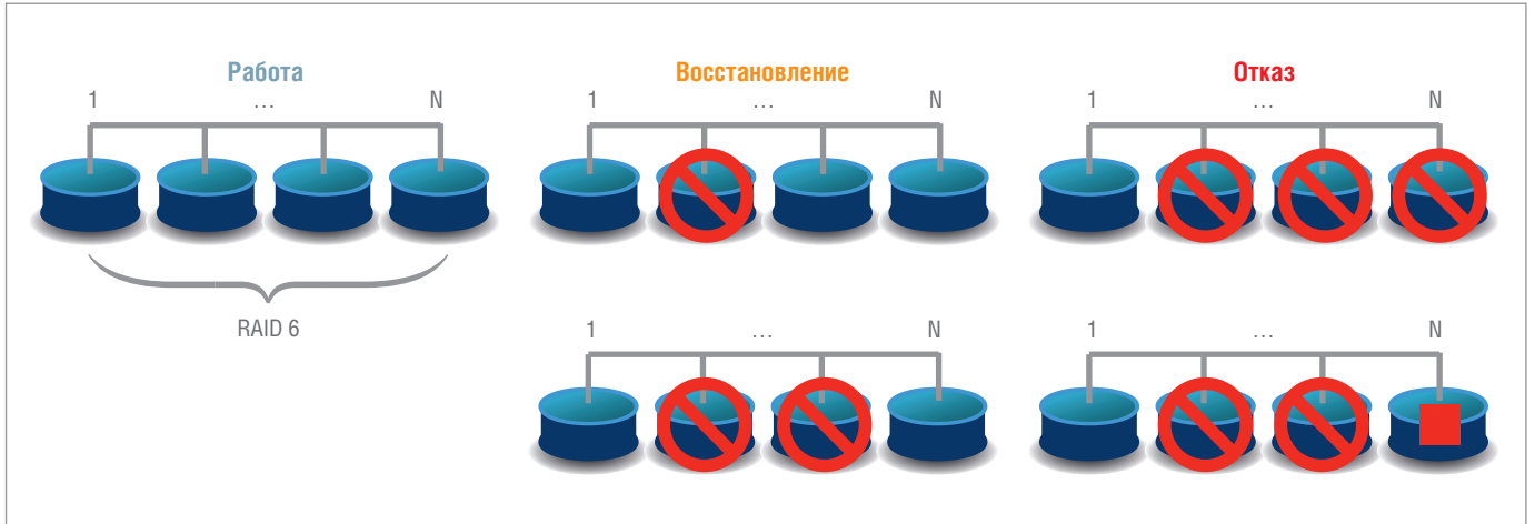
Рис. 5. Потеря данных для дискового массива RAID 6
