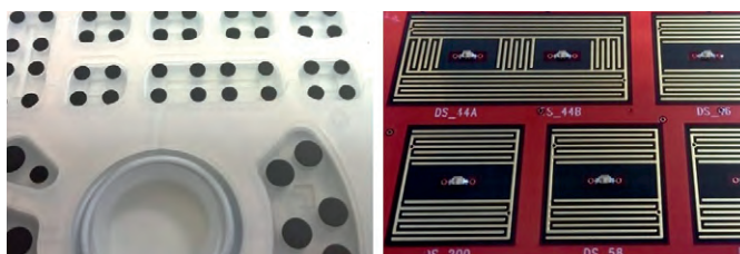
Рис. 1. Устройство резиномембранной клавиатуры
