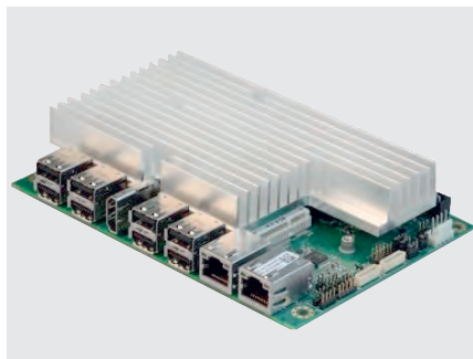
Рис. 3. Пример заказной несущей платы с пассивным охлаждением
