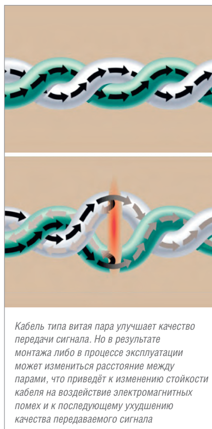
Рис. 2. Изменение расстояния между проводниками в витой паре
