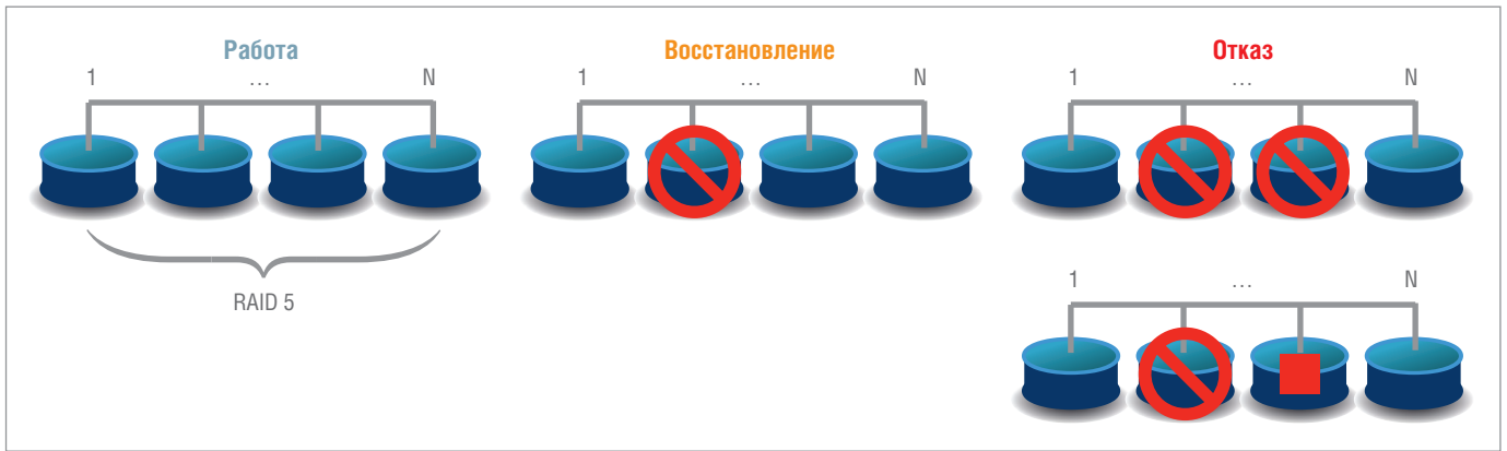
Рис. 4. Потеря данных для дискового массива RAID 5
