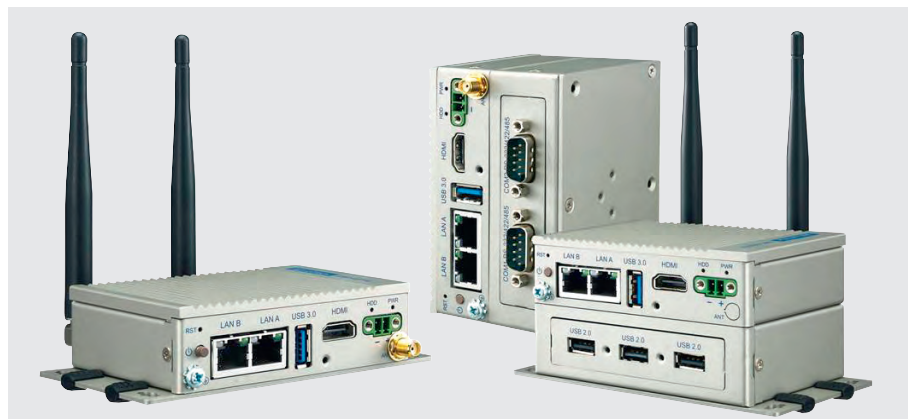
Рис. 2. Миниатюрный встраиваемый компьютер UNO-2271G
