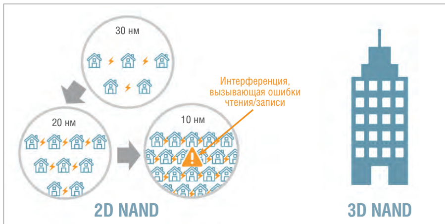
Рис. 1. Сравнение технологий 2D и 3D NAND
