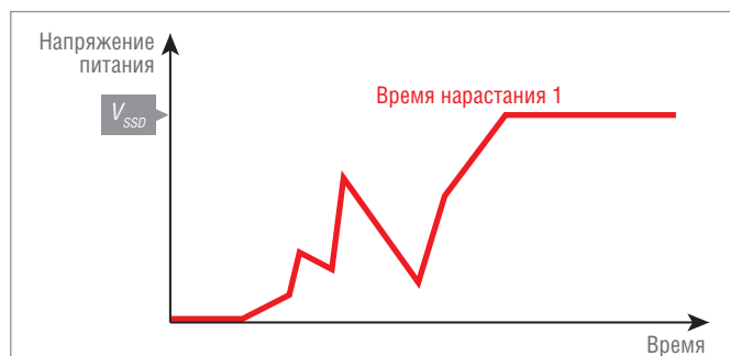
Рис. 2. Колебания напряжения при разгоне SSD
