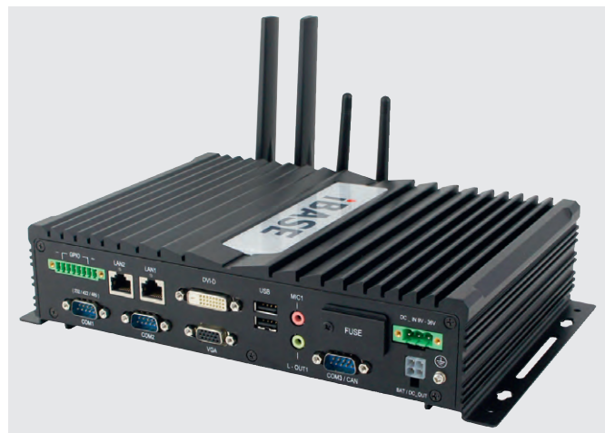
Рис. 4. MPT-3000V – компьютер, сертифицированный в соответствии с e-Mark для использования на транспорте
