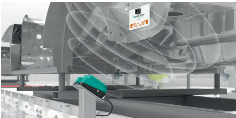
Рис. 4. Применение RFID-технологии на сборочном конвейере автозавода
