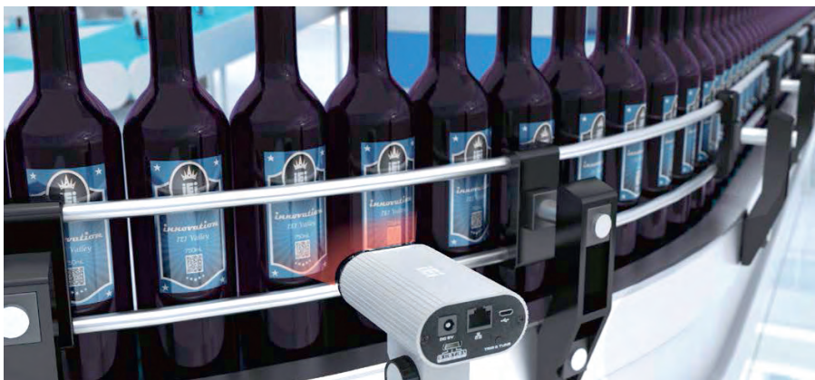
Рис. 5. Промышленная система машинного зрения на конвейере
