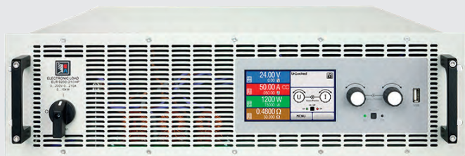
Рис. 5. Рекуперативная электронная нагрузка ELR 9000 3U
