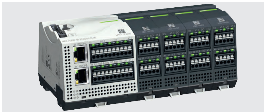
Рис. 3. ПЛК и модули ввода/вывода
