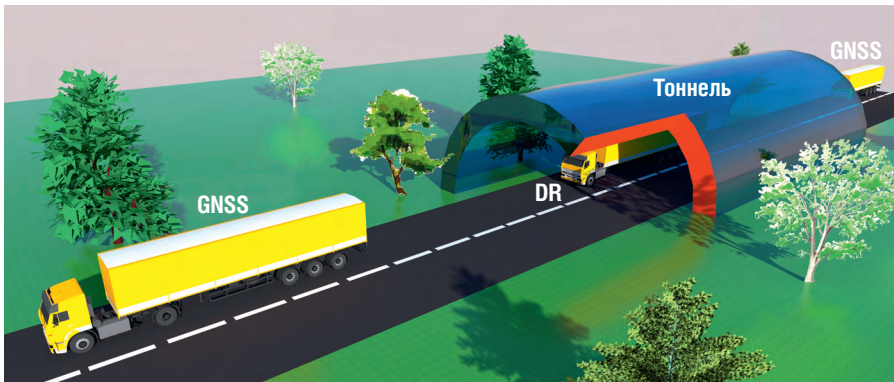
Рис. 5. Технология DR позволяет отслеживать транспорт в тоннелях
