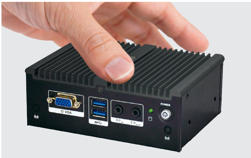
Рис. 10. Ультракомпактная встраиваемая система uIBX-250-BW
