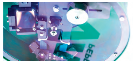
Рис. 3. Лазерный излучатель и камеры SpinScan3D
