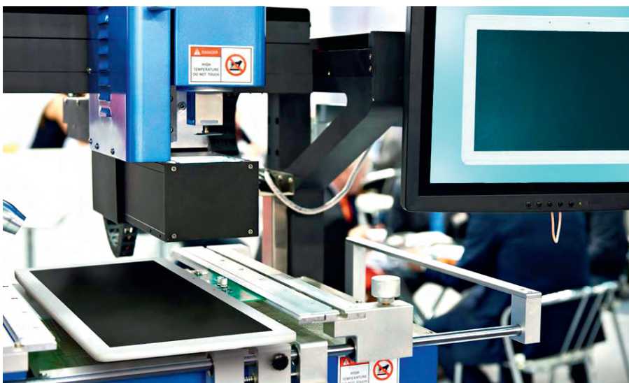
Рис. 6. Проверка качества ЖК-видеопанелей на конвейере
