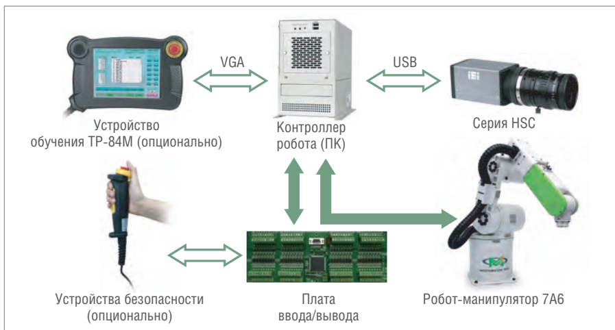
Рис. 2. Архитектура системы позиционирования
