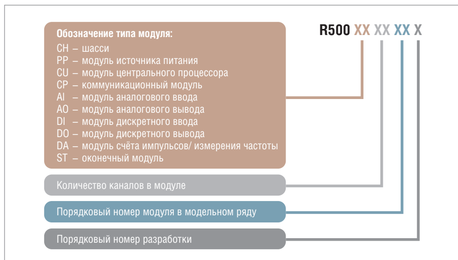
Рис. 3. Принцип кодирования модулей в модельном ряду Regul R500
