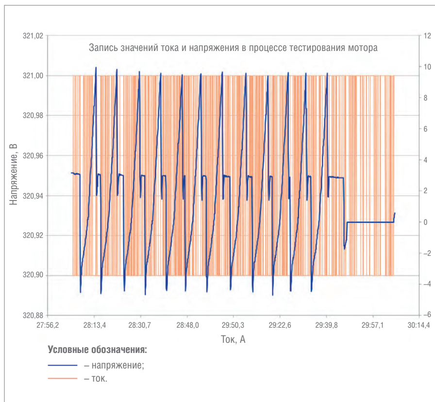
Рис. 11. Вольт-амперная характеристика 100-миллисекундных циклов испытаний
