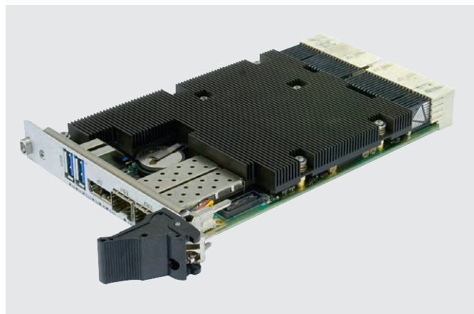
Рис. 3. CPC518 – высокопроизводительный модуль на процессоре Intel Xeon для задач уровня сервера
