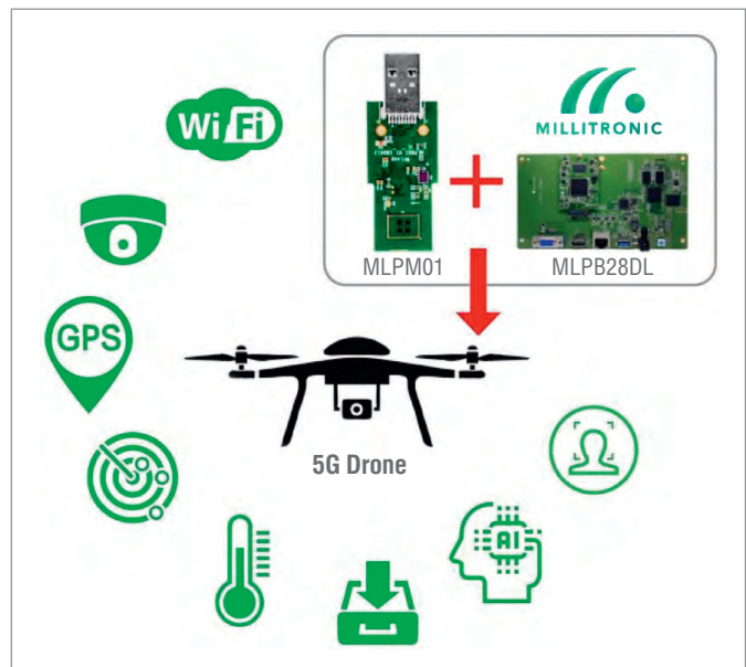
Рис. 2. Дрон с беспроводным гигабитным передатчиком
