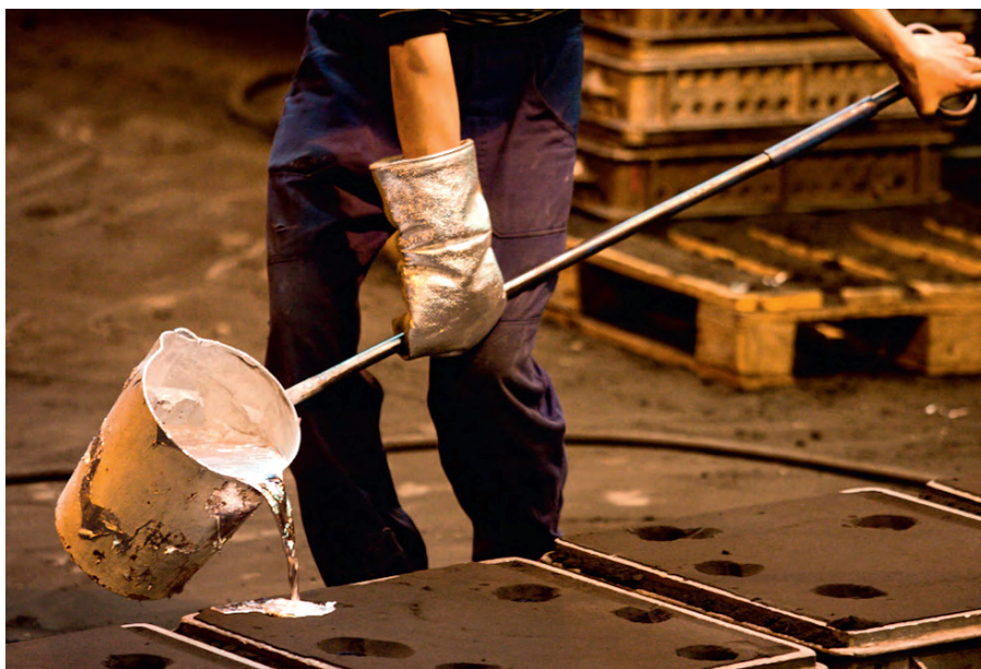
Рис. 1. Способ литья в песчаные формы — один из старейших и самый распространённый
