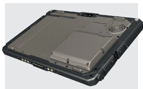
Рис. 6. Батарея-перемычка для возможности «горячей» замены
