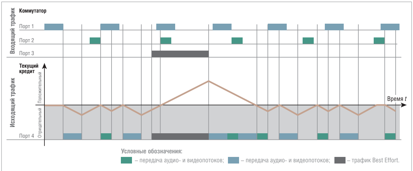
Рис. 1. Принцип работы формирователя профиля передачи трафика на основе кредитов (Credit-Based Shaper – CBS; IEEE 802.1Qav)
