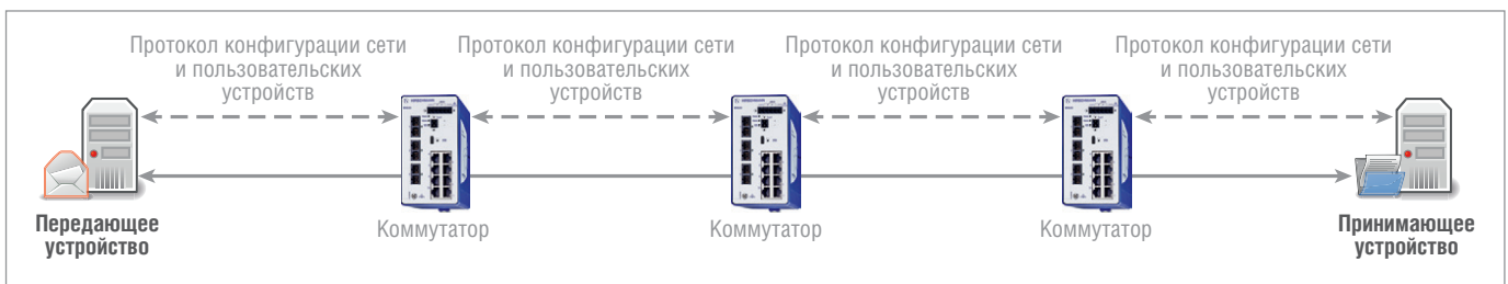
Рис. 4б. Вариант децентрализованной конфигурации TSN. Конфигурация механизмов TSN определяется на основе локальной информации, которая присутствует в каждом устройстве
