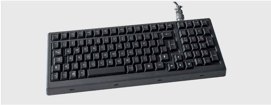
Рис. 11. Клавиатура для военных приложений MKB104
