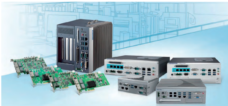
Рис. 8. Встраиваемые компьютеры, платы видеозахвата и готовые системы машинного зрения от Advantech
