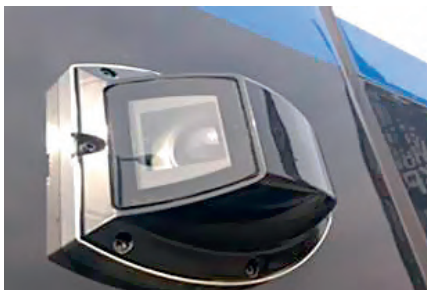
Рис. 10. Наружная установка камер в поезде дальнего следования
