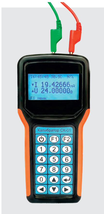
Рис. 2. Калибратор СК-01 в режиме генерация/измерение
