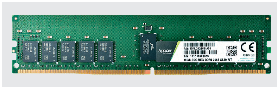
Рис. 4. Модуль памяти RDIMM
