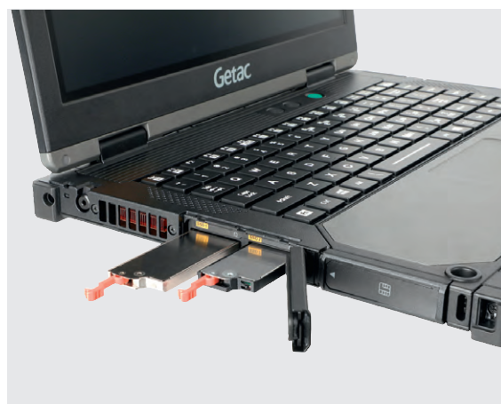
Рис. 2. Жёсткие диски модели V360
