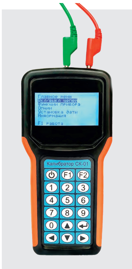
Рис. 1. Калибратор СК-01 в режиме меню
