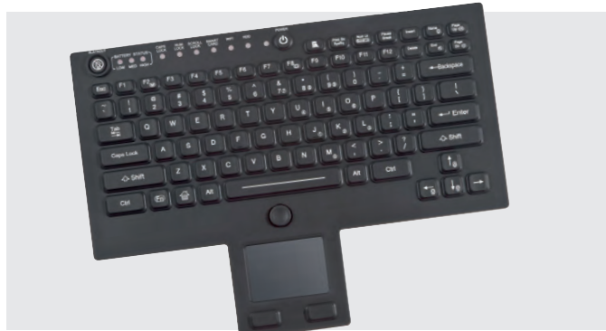
Рис. 9. Клавиатура TMLT-890-TP-OEM-USB/PS2 со встроенной сенсорной панелью
