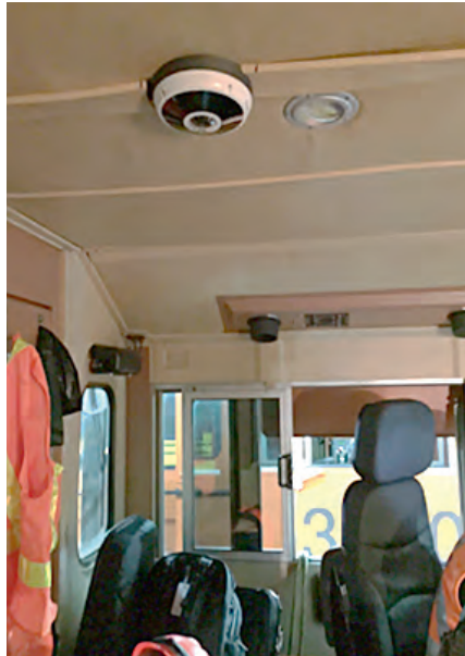
Рис. 9. Установка камер в кабине локомотива
