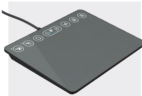
Рис. 10. TPD-55A326 – сенсорная панель со степенью защиты IP65
