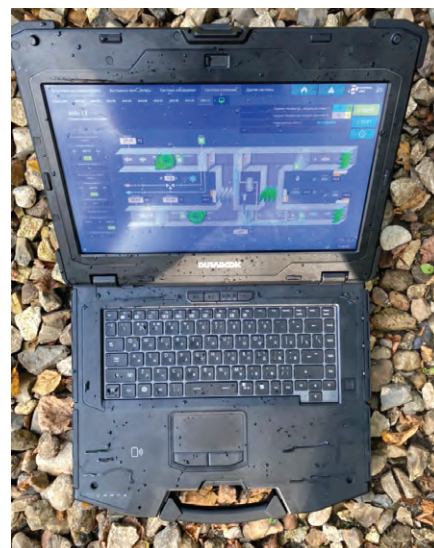
Рис. 4. Дисплей ноутбука Z14I под прямыми солнечными лучами
