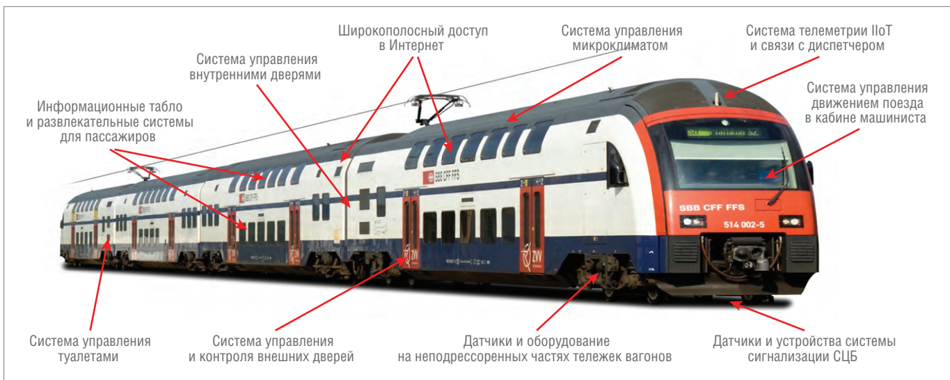
Рис. 1. Электронные системы, которыми оснащён современный поезд
