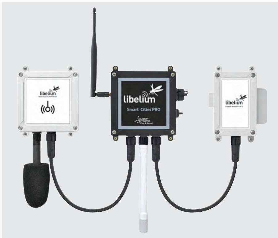
Рис. 12. Smart Cities PRO с интегрированными датчиками PM, уровня шума, освещённости
