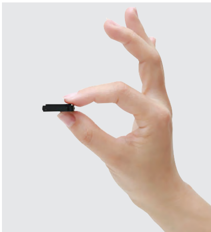
Рис. 3. Миниатюрный сканер рисунка вен ладони с размерами 25×25×8 мм
