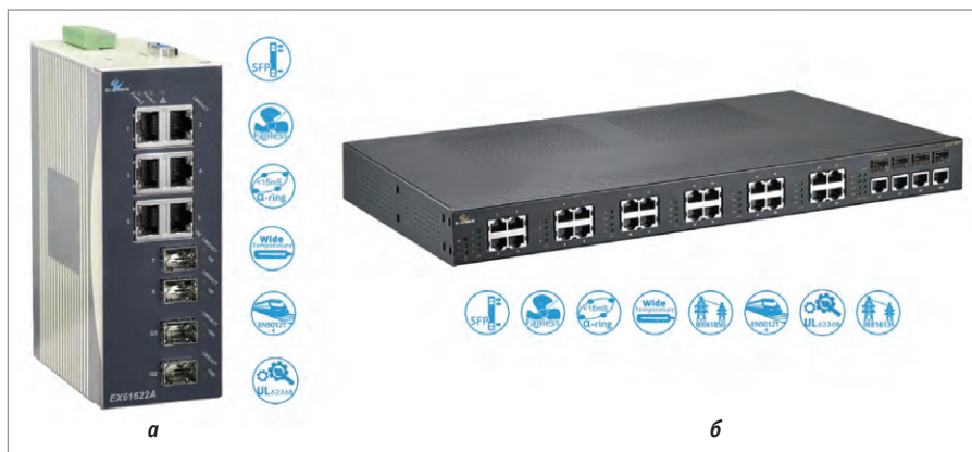
Рис. 1. Промышленные L2-коммутаторы EtherWAN: а – серия EX61000, б – серия EX27000
