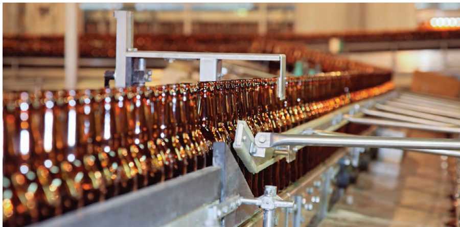
Рис. 2. Отбраковка и подсчёт бутылок на конвейере
