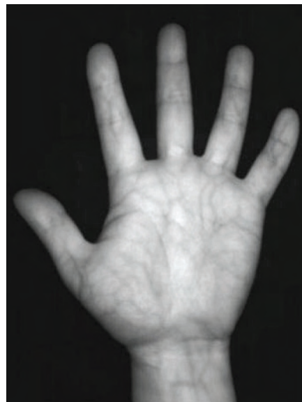
Рис. 1. Изображение рисунка вен ладони, полученное экспериментальным устройством
