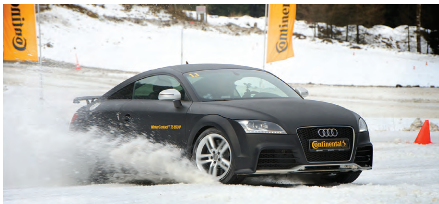
Рис. 5. Испытания шин WinterContact
